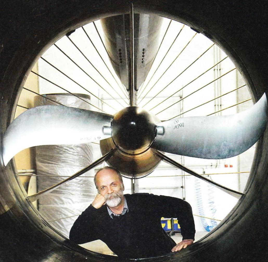
**Fritz Mondl,** der Erfinder der Stromboje, entwickelte die schwimmenden Kleinstkraftwerke zur Serienreife. Die fünf Tonnen schweren Aggregate werden per Katamaran zum Einsatzort gebracht und dort abgesenkt. Sie sind an einer 40 Meter langen Ankerkette befestigt, die sechs Meter tief im Flussbett einbetoniert wird.
