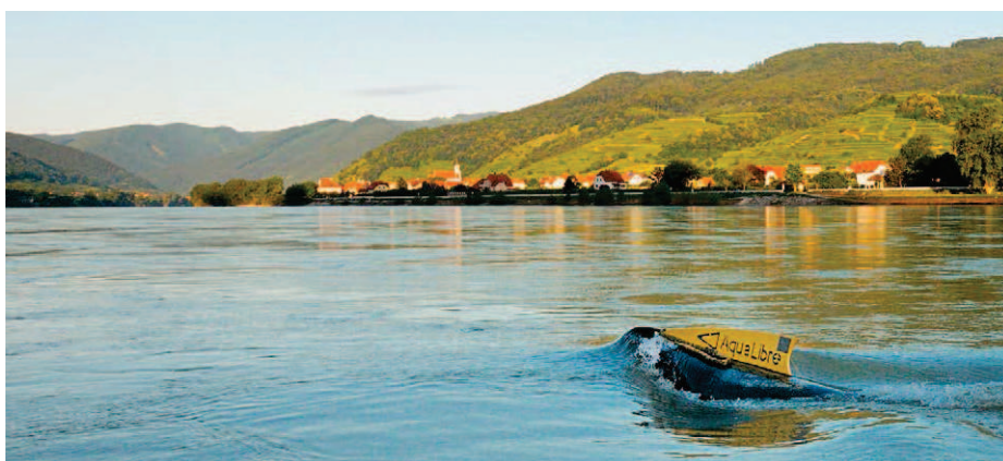
Eine Stromboje im Betrieb: sicher für Mensch und Fisch durch einen langsam drehenden Rotor und Rechen.
