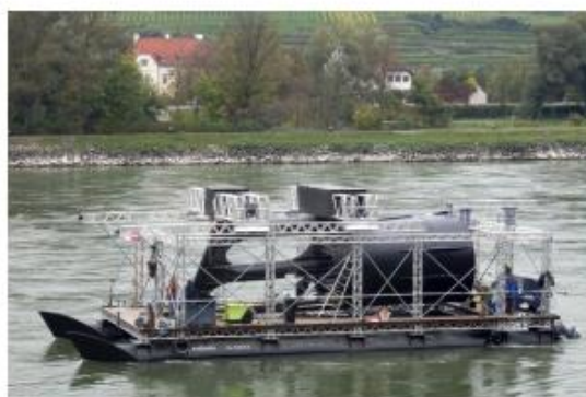
L'hydrolienne Aqua Libre près à être mis en place.
