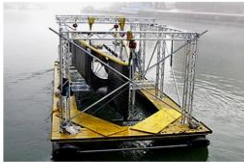
Strom-Boje beim Transport
