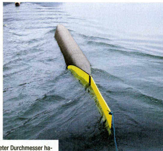
Turbine. 150 Zentimeter Durchmesser haben die Rotoren von Prototyp 1 (unten) und Stromboje 2 (oben, Länge zehn Meter).
